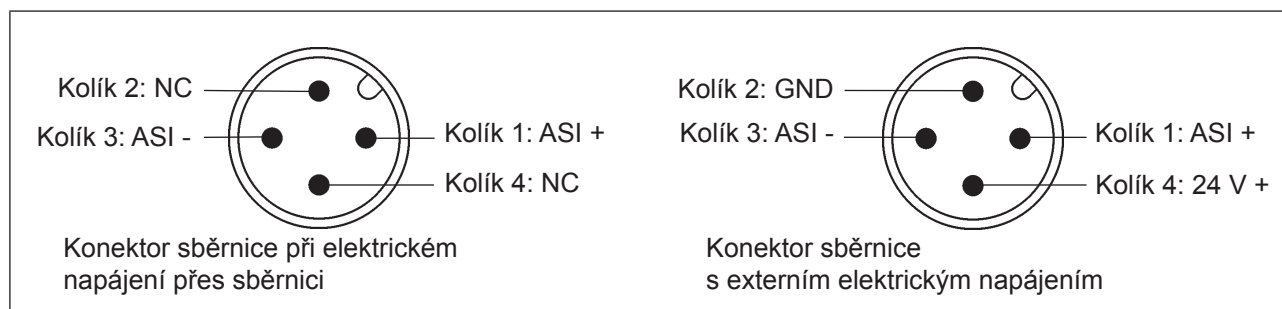
Obr. 18: Konektor sběrnice rozhraní AS (elektrické napájení přes sběrnici / externí elektrického napájení)
