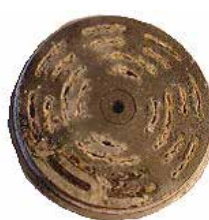
Без аэрозольного очистителя после 200 часов работы
