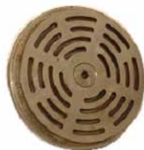
С аэрозольным очистителем после 2500 часов работы
