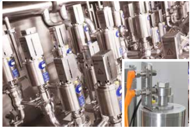
Vannes de traitement avec détecteurs de position et dispositifs supplémentaires de protection des doigts.
